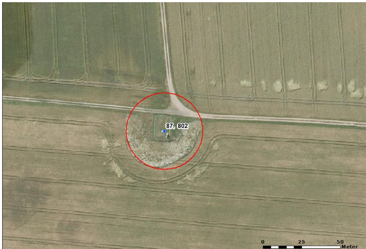
Figur 7.1 viser det boringsnære beskyttelses område (BNBO) inden for den røde afgrænsning. 25 m zonen omkring hver Indvindingsboring, udlagt i forbindelse med "Grøn vækst" er i dette tilfælde sammenfaldende med BNBO, og derfor også vist med rød.
